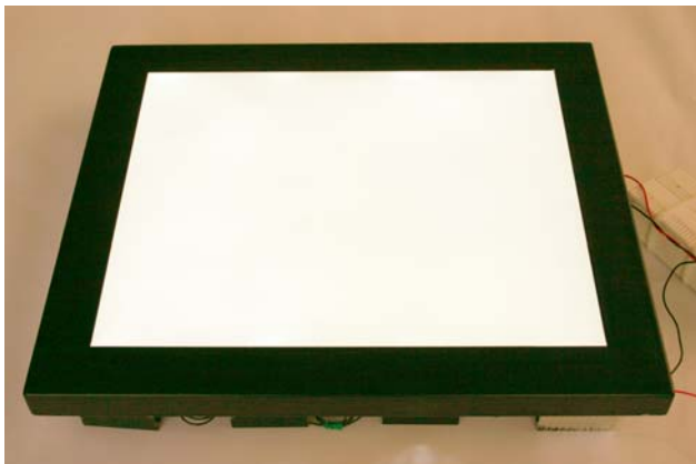
Pannello retroilluminato con led a iniezione laterale
